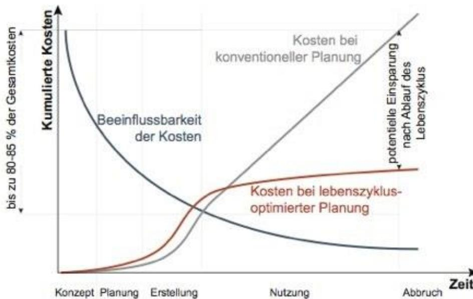
**Abbildung 6:** Kostenentwicklung bei Lebenszyklusoptimierter Planung<sup>1</sup> - Für die Wirtschaftlichkeit von Gebäuden und Anlagen sind die Kosten für den Gebäudebetrieb maßgeblich und lassen sich gerade in frühen Planungsphasen entscheidend beeinflussen.
