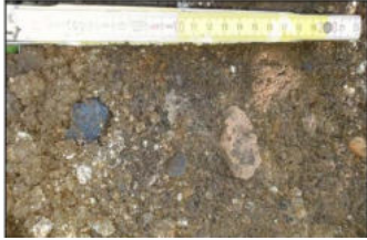
Abb.1 Material aus den Altablagerungen in dem verfüllten Graben entlang des Nordostrandes des Plangebiets; die Altablagerungen bestehen vorwiegend aus Asche, Schlacke und Bauschutt
