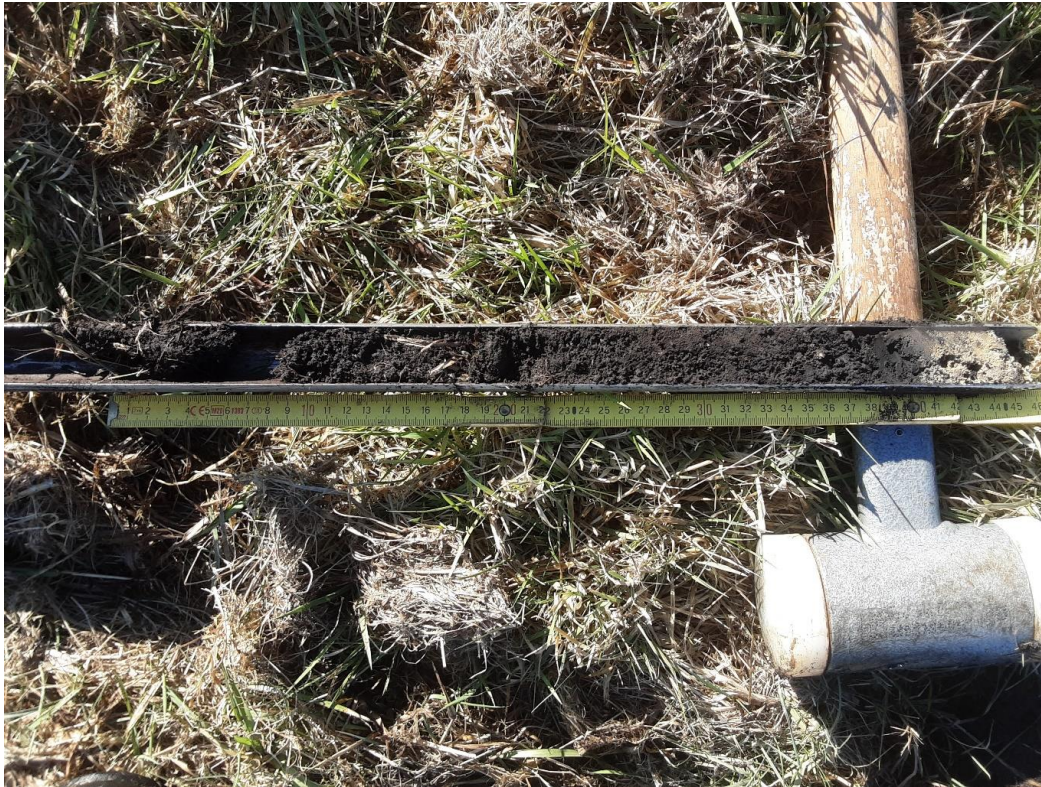
Beispiel: Bohrstock mit hochzersetztem, vererdetem Torf (dunkelbraun) und mineralischem Boden (sandfarben)
