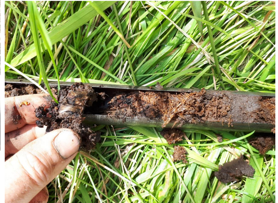
Beispiel: gut erhaltener Torf im Bohrstock, Holzreste
