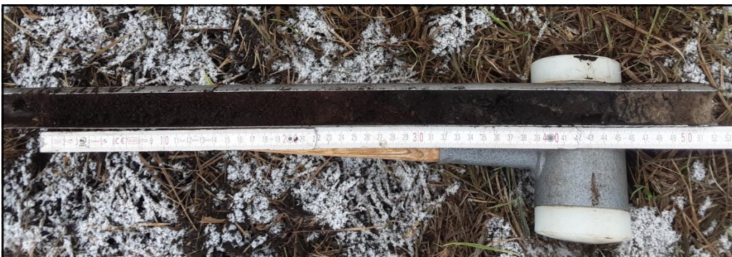
Abb.3: Bohrkern mit 45 cm Antorf über Sand in Reinberg.
