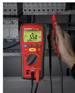
VDE 0100 Prüfgerät BENNING IT 101 bei der Isolationswiderstandsmessung einer elektrischen Anlage
