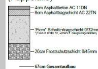
Regelschnitt Asphaltdecke RSTO 12: BK, 0,3, T.1, Z.3 (Pappelallee)
