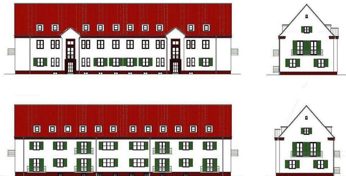
Abb. 32: Rekonstruktion einer Fassade mit auskragenden Balkonen
