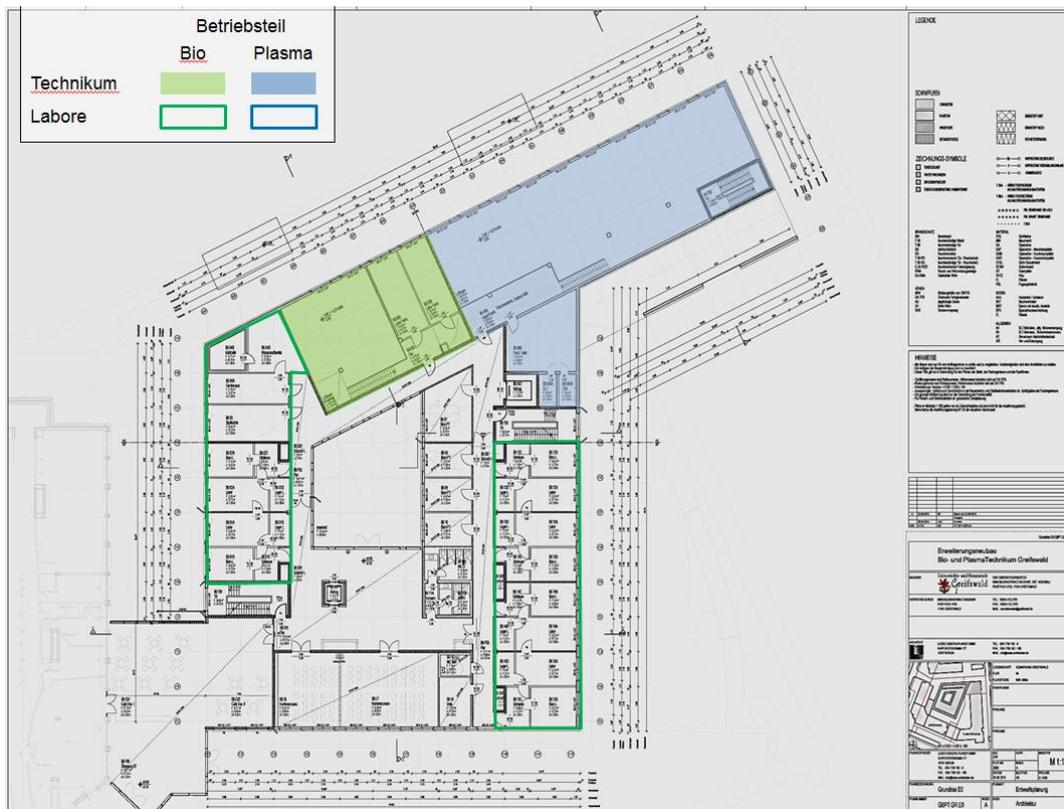
Grundriss Erdgeschoss mit Fermenterbereich und Produktionshalle Plasmatechnik
